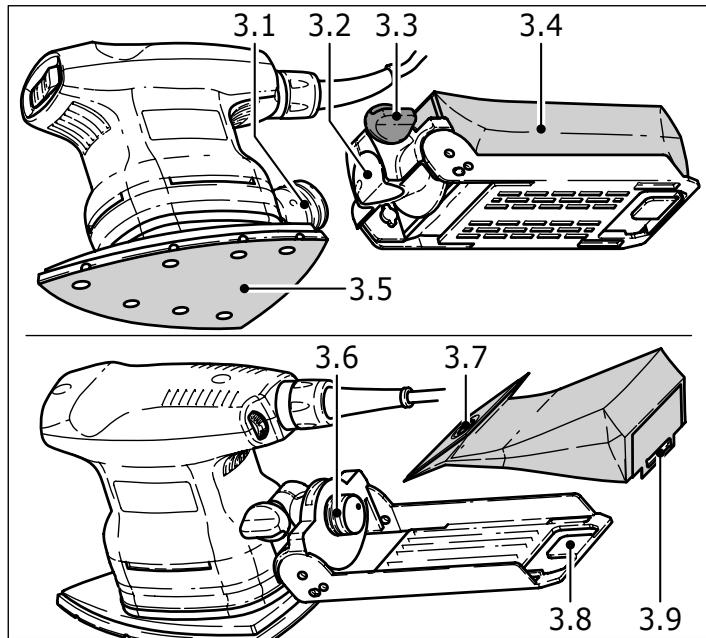
Las máquinas están equipadas como equipo de serie con un dispositivo autoaspirador. El polvo de lijado es aspirado por las aberturas de aspiración que se encuentran en el plato de lijado (3.5) y es recogido en el turbofiltro (3.4).
